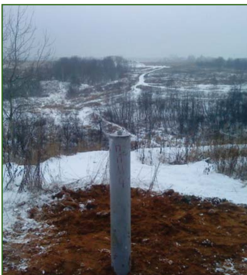
Рис. 4 Пункт принудительного центрирования на объекте
